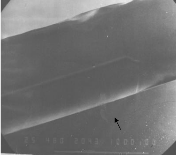
Рис. 2. Растрові електронні мікрофотографії поверхні кремнію, опроміненого протонами ( E = 6,8 МеВ, \Phi = 10^{17} см ^{-2} , напрямок опромінення [110] паралельний даній площині).
