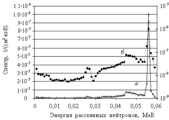
Рис. 6. Расчет усредненного по объему счетчика спектра нейтронов, рассеянных под углом 45^\circ , в условиях реального эксперимента: образец – бериллий, толщина по пучку 0,4 мм, радиус 14,6 мм. Радиус пучка 10 мм. a – построено в линейном масштабе по вертикали, левая шкала; b – в логарифмическом масштабе, правая шкала.
