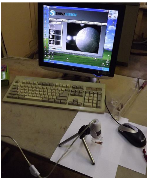
Рис. 3. З'єднаний із комп'ютером цифровий мікроскоп (зліва). Зображення двох різних ділянок поверхні тонкої плівки \text{CH}_2 , що ілюструють можливості виявлення її дефектів (справа).
