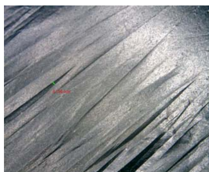
Рис. 3. З'єднаний із комп'ютером цифровий мікроскоп (зліва). Зображення двох різних ділянок поверхні тонкої плівки \text{CH}_2 , що ілюструють можливості виявлення її дефектів (справа).
