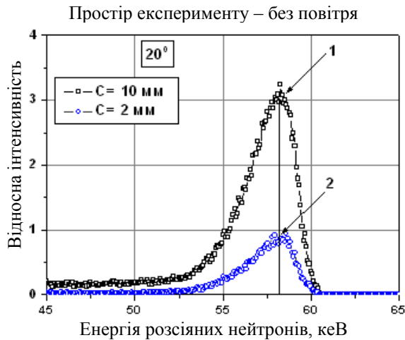
Рис. 1. Розрахункові спектри розсіяних нейтронів під кутом 20° на вуглеці для фільтра 59 кеВ. (Див. кольоровий рисунок на сайті журналу.)
