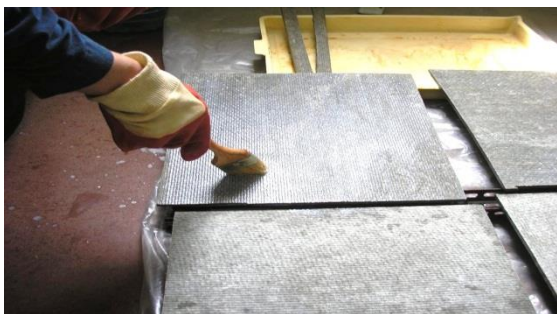
Рис. 3. Технологічний процес радіаційно-хімічної модифікації: механічне нанесення олігомеру на поверхню зразків шиферу (зліва); зразки на конвеєрі транспортної лінії (справа).
