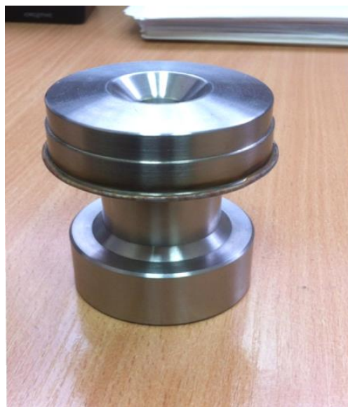
Рис. 2. Дослідний зразок мішені, що обертається.
