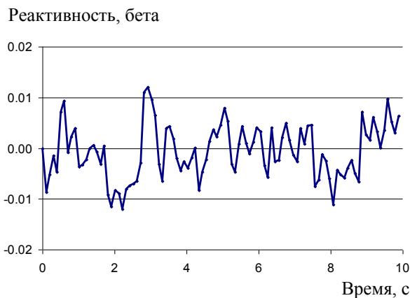
Рис. 1. Изменение реактивности в активной зоне ВВЭР-1000 по сигналу внезонного нейтронного детектора.
