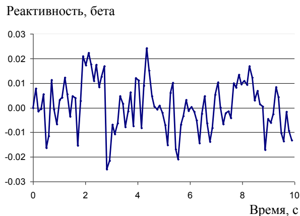
Рис. 2. Изменение реактивности в активной зоне ВВЭР-1000 по сигналу внутризонного нейтронного детектора.
