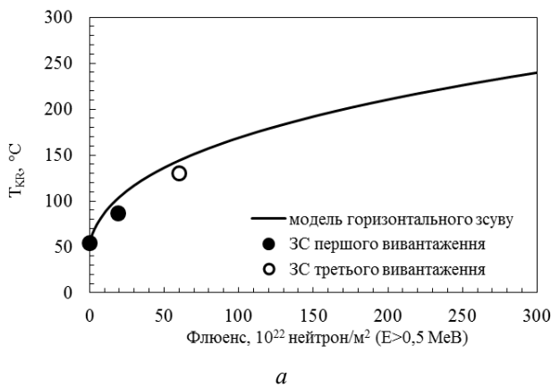
Рис. 8. Залежність критичної температури крихкості від флюенсу швидких нейтронів для груп МШ РАЭС-1 (НФ) (а) і МШ РАЭС-1 (ВФ) (б) при повторному після відпалу опроміненні.
